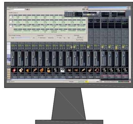
Прослушивание стерео микса из цифровой станции можно произвести выбором ZED R 16 MAIN L R в качестве выхода для мастер дорожки в цифровой станции и вернуть его в мастер секцию ZED-R16.
